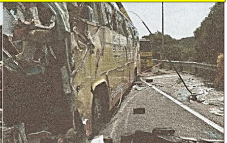
左側車身多處大面積刮擦痕跡
