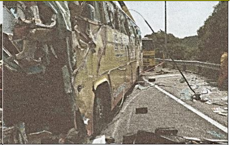
左側車身多處大面積刮擦痕跡
