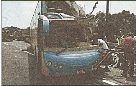
前車頭受損，擋風玻璃破裂
